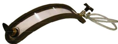
Die durchsichtige Scheibe besteht aus Makrolon und ist dem Rohrdurchmesser entsprechend angepasst. Die Moosgummidichtung garantiert, dass die Brille unter Vakuum zu 100% auf der Oberfläche des Prüfteils anliegt.
