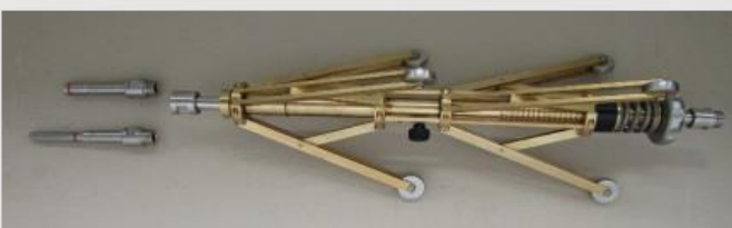
Anwendungsbeispiel als Innenrohr für Rohrwagen 1.1
